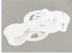
Bauteil ohne Stützkonstruktion
