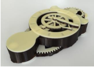
Bauteil mit Stützkonstruktion
